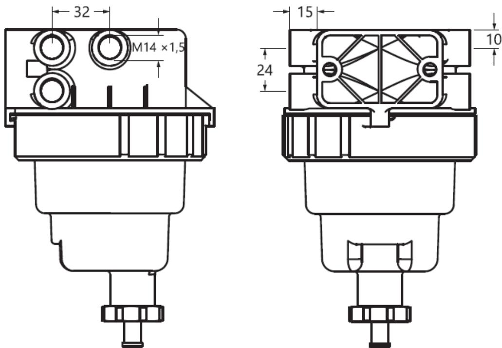
M14x1,5: Torque 14 Nm  $\pm$ 1 Nm
