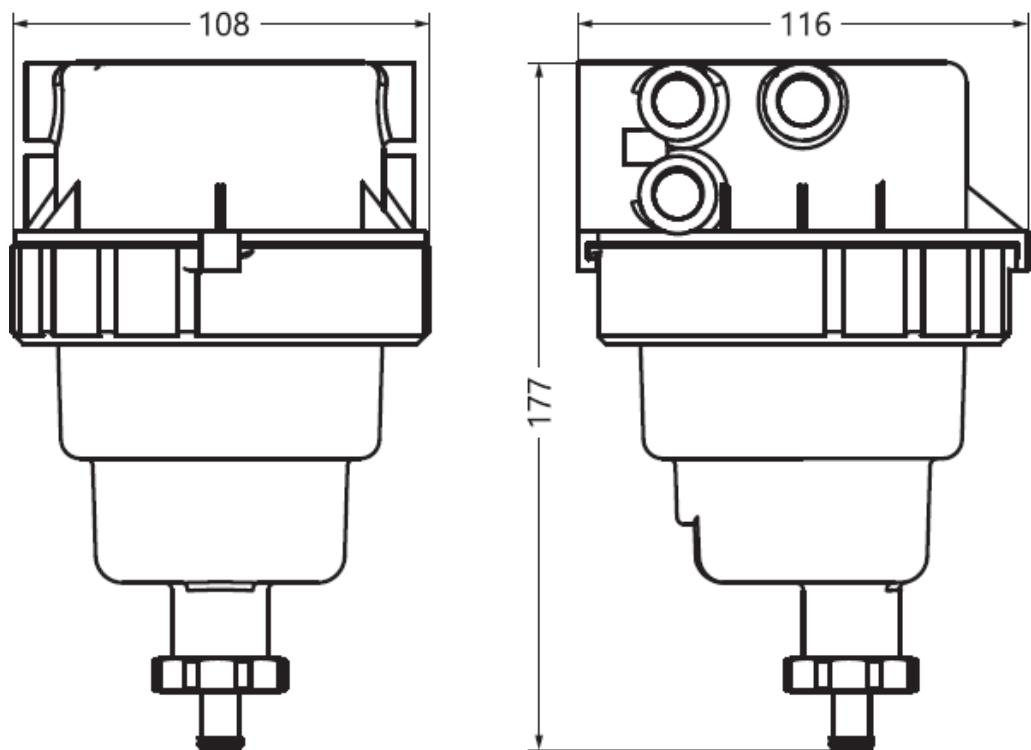
Abbildung 2: Abmessungen
